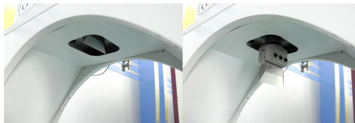
Velocità di impatto selezionabile (10-15-20 m/s) Selectable impact speed (10-15-20m/s)
