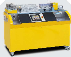
Linea di granulazione con estrusore mono vite
