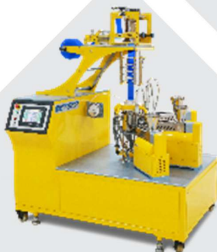
Linea per film in bolla co-estruso a 3 strati (A-B-C)
