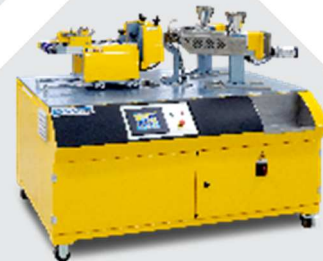
Linea per film co-estruso a 3 strati in foglia (A-B-C) (A-B-A)
